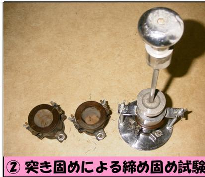
② 突き固めによる締め固め試験
